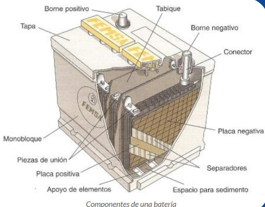
La batería de un automóvil es un componente crítico para su funcionamiento adecuado, y mantenerla en buen estado es esencial para evitar problemas de arranque y garantizar el funcionamiento de los sistemas eléctricos del vehículo.
