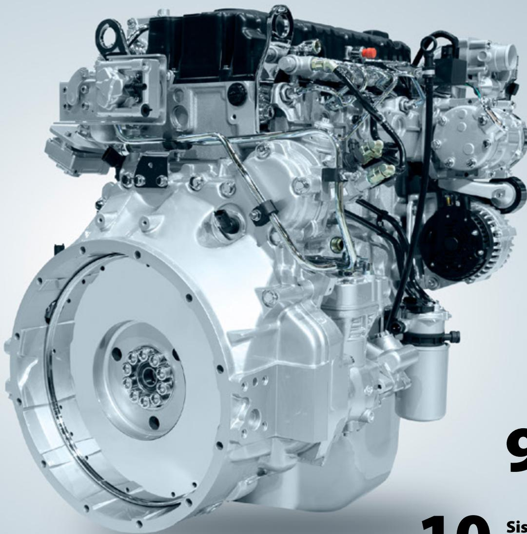
**4 Culata:** La culata es la parte superior de los cilindros y se fija al bloque del motor. Contiene las válvulas de admisión y escape, así como la cámara de combustión.
